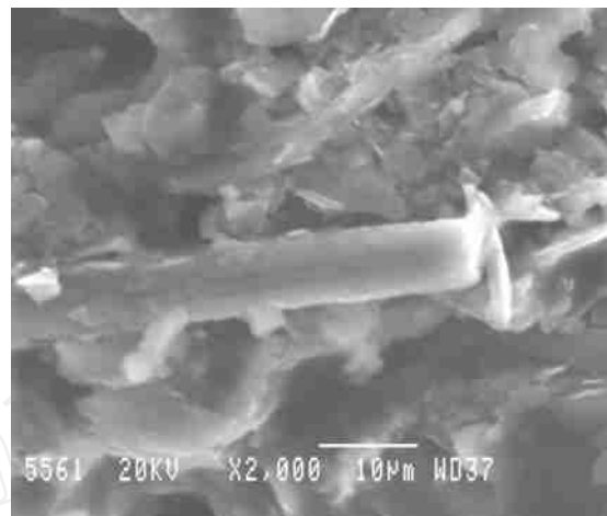
图 2 断口 SEM 形貌(碳纤维进行空气氧化处理)
