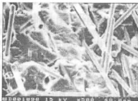
图 8 20mm 玻纤/PP 复合材料的平行冲击断面
