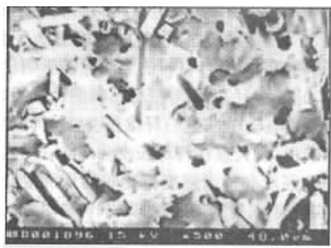
图 9 20mm 玻纤/PP 复合材料的垂直冲击断面
