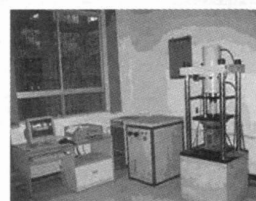
图 1 YAW - 500 型压力机
